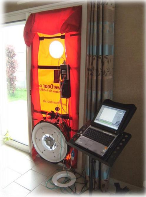
Un ordinateur permet de collecter les données ; fumigène, anémomètre et caméra thermique permettent de repérer les fuites anormales.
