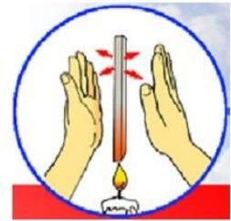
La chaleur se dissipe en deux temps : 1) En chauffant notre habitation les calories produites atteignent les parois extérieures par **convection** et par **rayonnement**. 2) les calories passent au travers de l'enveloppe (donc s'échappent) par **conduction**.
